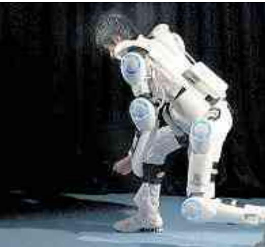
Ein sogenannten Exoskelett kann gelähmten Menschen helfen, die Gliedmaßen zu bewegen.
