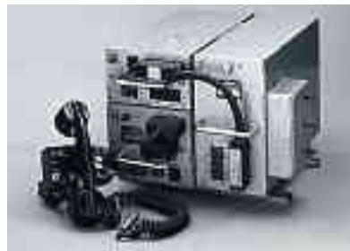
Mobiles Telefon von 1956. Der handliche Apparat wog 45 Kilogramm.
