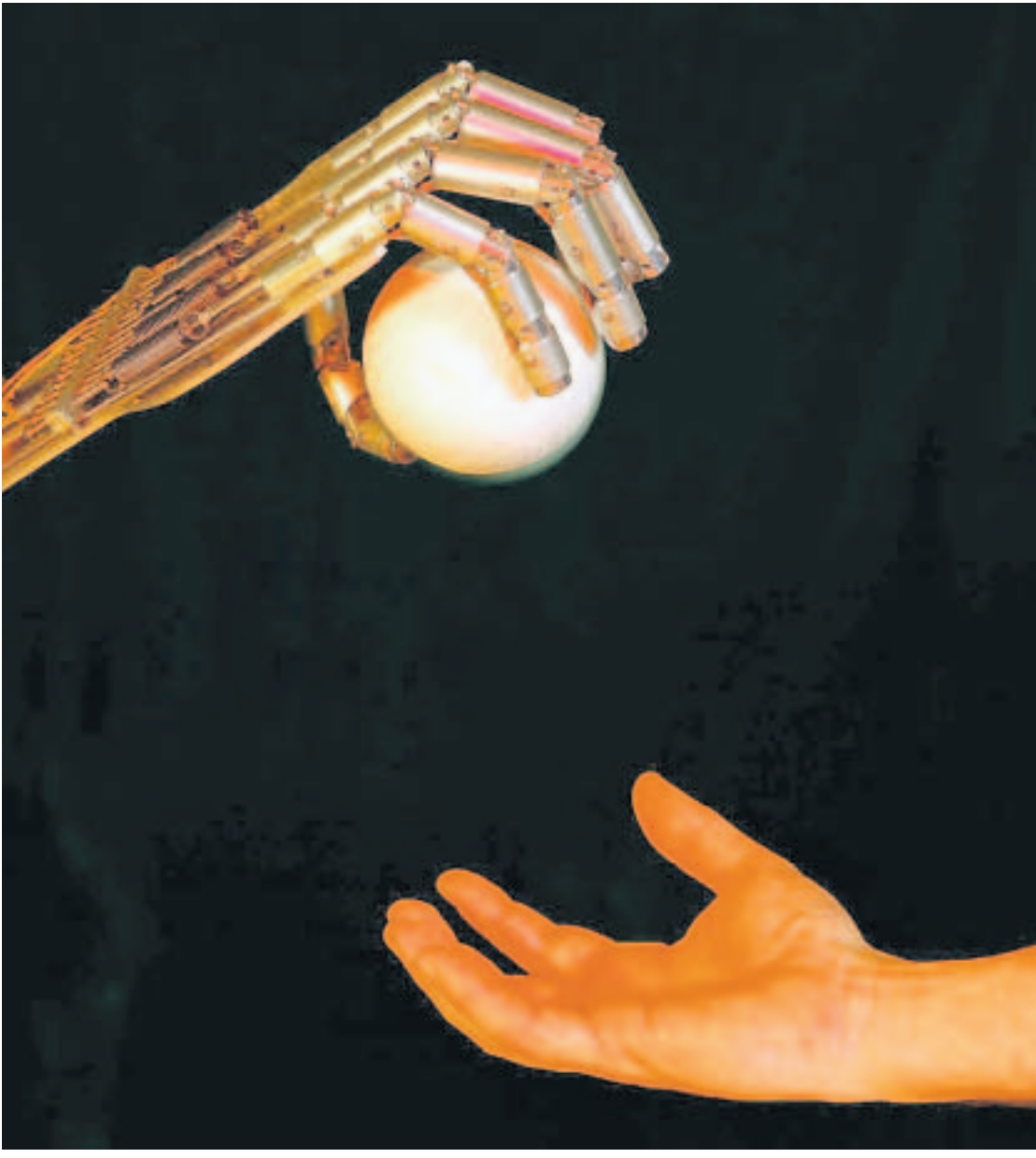
BERLINER ZEITUNG/FRED ENGLSMANN Sie kann greifen und bald auch fühlen – bei der bionischen Hand „Beuth 2“ ersetzen kleine Servomotoren die Muskeln, und Textilbänder die Sehnen. Druckempfindliche Sensoren sollen den Tastsinn nachahmen.
